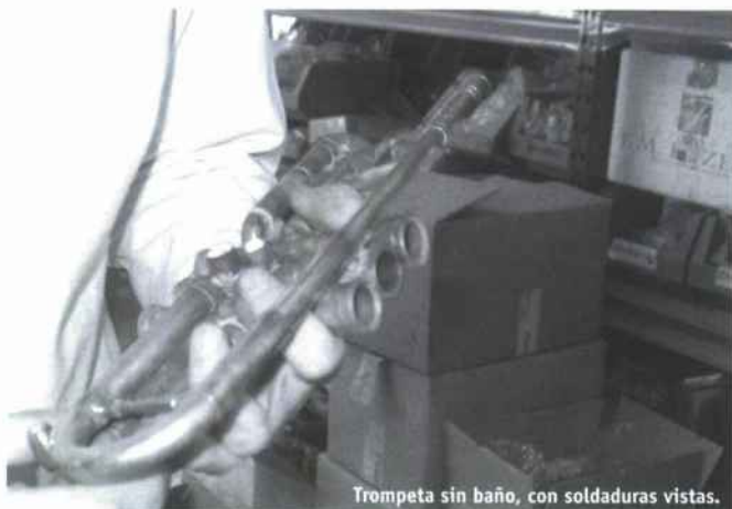
Trompeta sin baño, con soldaduras vistas.
