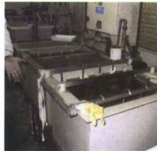
Proceso de fabricación de instrumentos con baño de plata.
