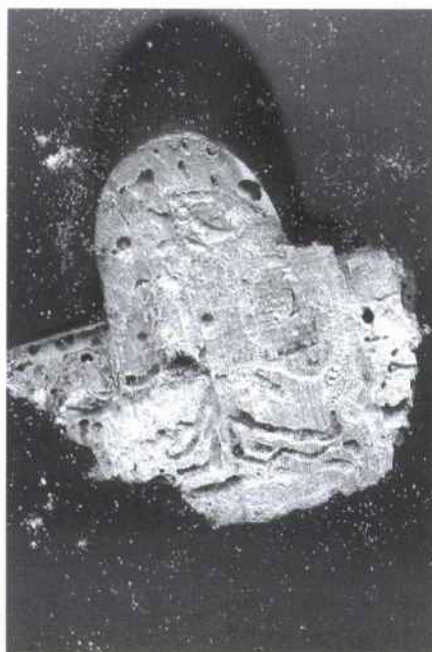
"Taco superior de un chelo con una parte del mango. Exteriormente se aprecian apenas tres agujeros. Dentro, la estructura de la madera está totalmente destruida por la carcoma."
