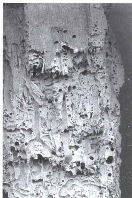
"Taco superior de un chelo con una parte del mango. Exteriormente se aprecian apenas tres agujeros. Dentro, la estructura de la madera está totalmente destruida por la carcoma."
