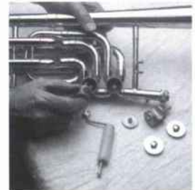
Sistema estandar de transpositor en un trombón Bach.
