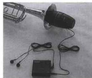
El sistema Silent Brass de Yamaha, permite al instrumentista tocar en cualquier sitio y momento que desee con el tipo de ambiente que le apetezca. Se puede mezclar sonidos de un reproductor de CD, otros con instrumentos o con salida electrónica como los Clavinovas, pianos Silent, sintetizadores o teclados electrónicos y también permite enviar su interpretación a cinta o incluso a un amplificador con altavoces. Incluye auriculares y adaptador. (www.yamaha.es)
